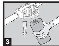
3 Com uma luva, retire o elemento filtrante cheio de impurezas.
