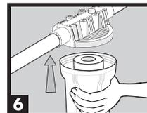
6 Encaixe o novo elemento filtrante dentro do copo e enrosque o copo de volta na tampa. Abra novamente o registro do hidrômetro.
