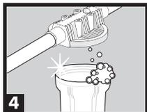
4 Faça uma limpeza do copo e da tampa do filtro. Utilize apenas água e sabão biodegradável. Evite materiais abrasivos.
