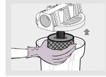
Com uma luva, desenrosque o refil cheio de impurezas. Lave a tampa, o anel o'ring e o copo do filtro.
